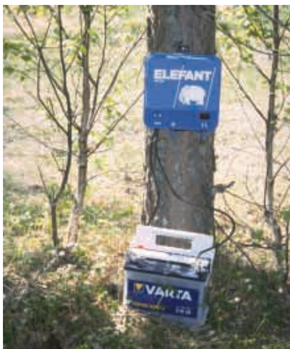
Bild 5. Elaggregatet kan drivas med bilbatterier när det är långt till nätanslutning. Batteriet kan kompletteras med solceller.
